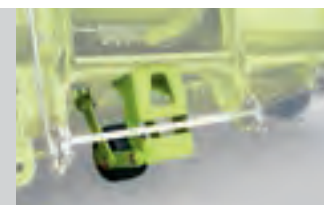
最適な圃場追従のための サポートホイール
