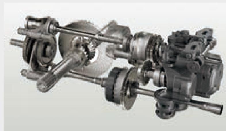
フェントバリオトランスミッションは、油圧機械式のパワースプリットドライブです。回転数が増えるにつれて、プラネタリーギヤセットによる機械的動力伝達分が増加します。45°までスイング可能な油圧ポンプは、最大 550bar の作動圧力を誇り、驚くべき効率を発揮します。
