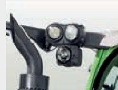
☞ 700 バリオのランプ配置はユニークなもので、各作業灯が意図的に斜めに配置されています。これにより、オペレーターは、影や反射の無い最適な視野の恩恵を享受できます。
