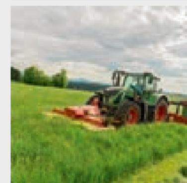
フロントリンケージのロードリリーフコントロールは、凹凸のある地面に対して作業機の追従を素早く調整できるため、スノーブラウフロントモアコン作業時に特に有効です。
