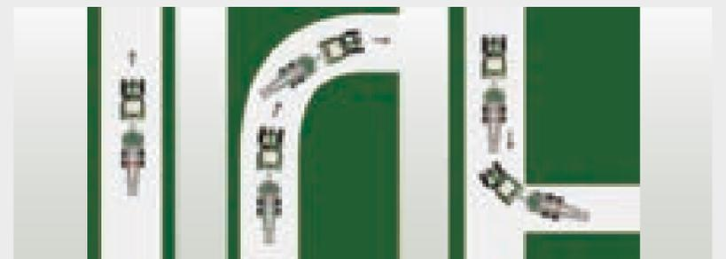
オプションの自動トレーラー steering ロックは、トレーラーの steering のロックを設定速度で自動的に解除します。直進時は、steering をロックする事によりハンドリングが安定します。速度が設定値の範囲外の場合または後退する場合、オペレーターがトレーラーの steering を手動でロックする必要はありません。
