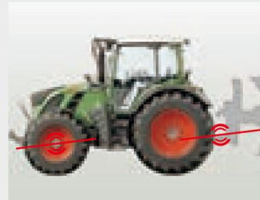
トラクターと作業機が荒れた路面で激しく上下動するような場合でも、ショックロードシステムが油圧を使用した動きで揺れを打ち消します。ピッチングが減少するため、ステアリングの安全性が高まり、乗り心地が向上します。
