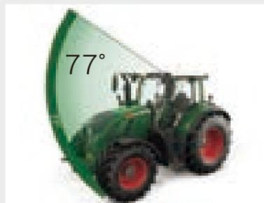
上下方向視野角 77° のフロントガラスにより、上方からホイールアーチまで上下を完全に見渡せます。
