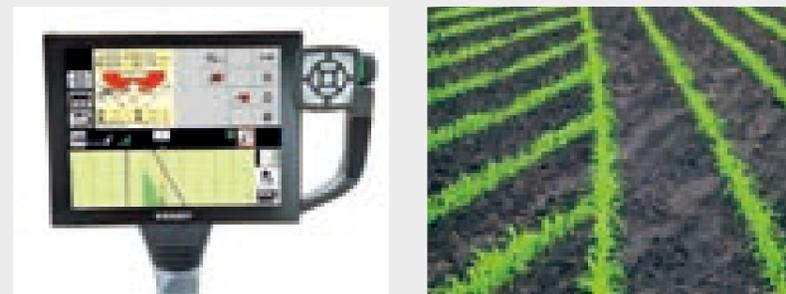
バリオトロンニック操作インターフェイスに組み込まれた完全自動のセクションコントロールは、GPS 信号を使用しつつ、予め設定したオーバーラップを基準に動作します。ISO-BUS 対応のスプレーヤー、ブロードキャスター、シードドリルを使用している場合、最大 24 セクションを設定できます。結果として正確な作業結果により重複や圃場外への散布等を避けることができるため、種子、肥料、または農薬が節約できます。また、これにより昼夜を問わず作業が容易になります。
