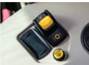
右側コンソールにあるスイッチで PTO コントロールを行います。
