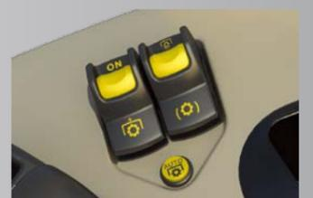
PTO の ON/OFF は右側コンソール内のスイッチで簡単に操作可能
