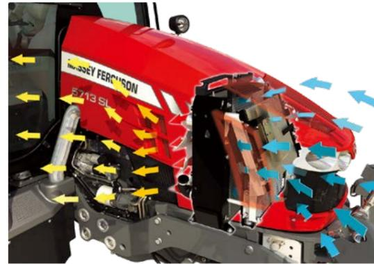
幅広いグリルと各コンポーネントの下のスペース、ラジエーターは新鮮な空気に触れながら最適な冷却が行われます。
