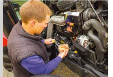
冷却システムもアクセスしやすい場所に配置され、清掃、メンテナンスが簡単に行えます。エンジンエアフィルターにもすぐに手が届く設計です。
