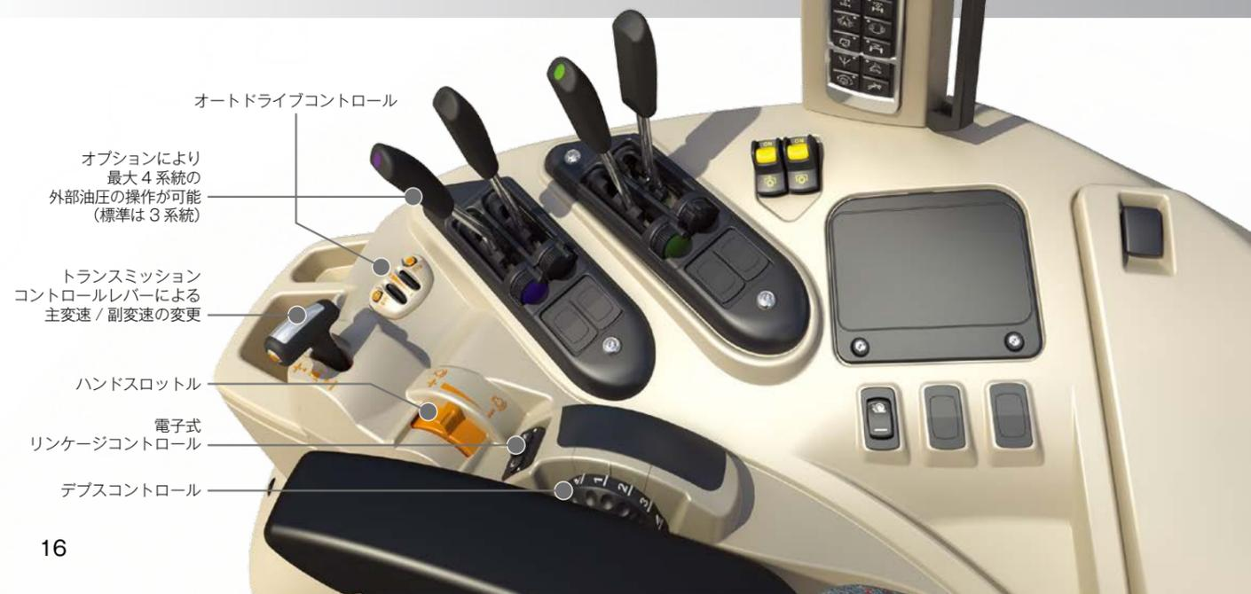
**機械式マルチファンクションローダージョイスティックレバーによる Essentialバージョンのキャブコントロール**
