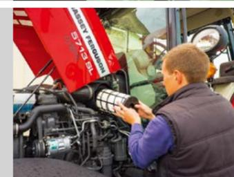
コンパクトな冷却システムはスリムで幅の狭いボンネットを構成し視認性を高め、新鮮な空気が循環し清掃やメンテナンスがしやすいだけの十分なスペースを維持しています。
