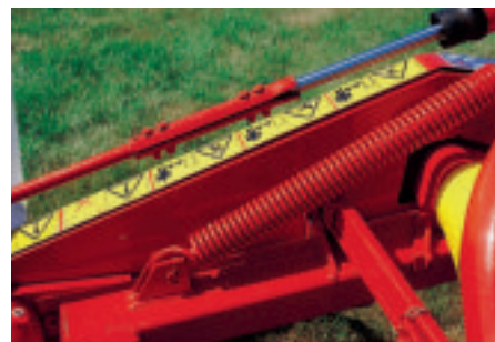
圃場へ正確に追従するためのサスペンションスプリング
