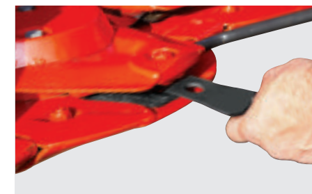
FF：ファストフィット装備 ナイフを簡単に変える事ができます。
