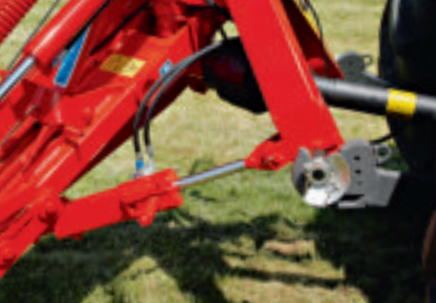
搬送時や障害物衝突時に機体を補助する油圧ピボットシリンダー（オプション）
