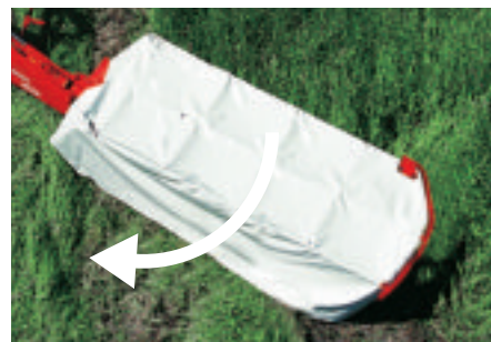
安全なブレークアウェイ構造
