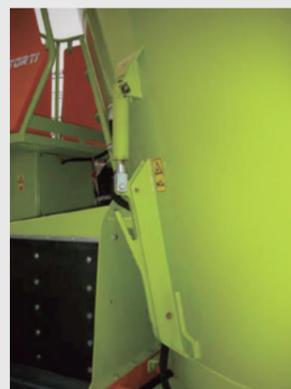
チャンバー外側から見たカウンターブレードを調整するための油圧ホイスト
