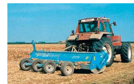
RMモデルには、鉄製ローラーが標準装備。ステアリングホイールはオプションで、MSK仕様は2本となります。
