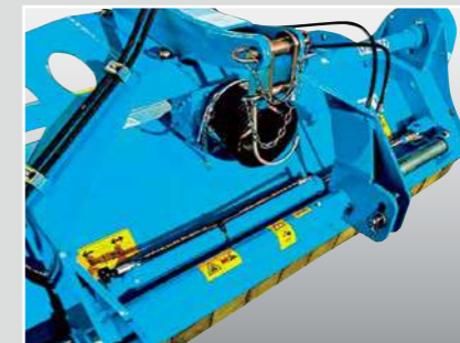
油圧式オフセットを動かす事で、端まで綺麗に刈取る事が可能。
