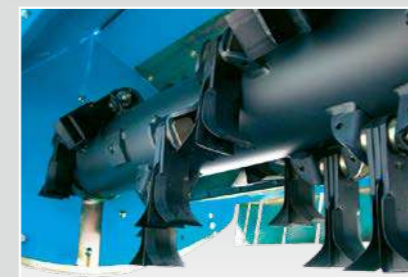
620mmの大径ローターが多量のシュレツディングを可能に
