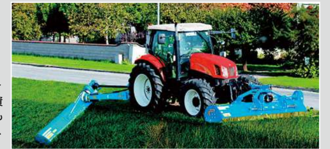
自動ベルトテンションを装備しているので常に安定した動力伝達が可能。
