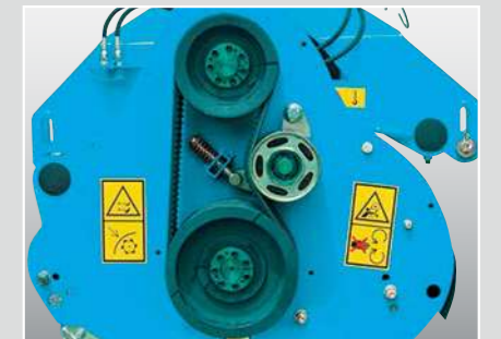
自動ベルトテンションを装備しているので常に安定した動力伝達が可能。
