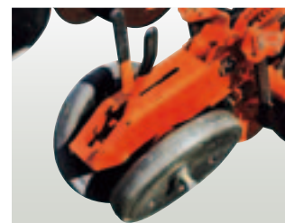
ラバー HD リアローラー (250/500mm、ノッチ式またはスチール)： コールトアー圧の増加、砂の多い圃場で活躍 (500mmHD ラバー標準装備)
