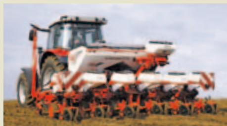
調整式テレスコピック：45～80cmに畦間調整が可能 (メーカー型式：TI)
