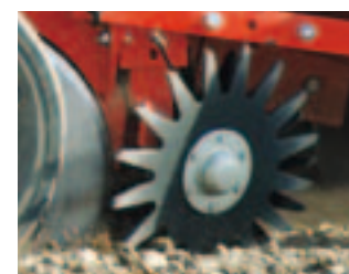
星型トラッシュリムーバー： 種子と残渣物の接触を防止（オプション）
