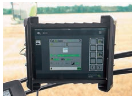
クラスが新たに開発したISO UTコントロールシステム。 Bluetoothを使うことで、iPad経由でワイヤレスコントロールが可能。
