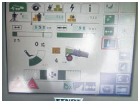
ISOBUSを使ったフェントトラクターのバリオターミナルへの接続
