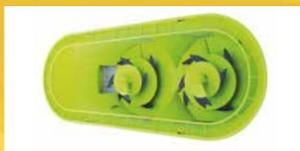
左の図にあるように、タンク内の飼料を上下に動かすことにより、素早く効率的に切断・攪拌作業を行います。
