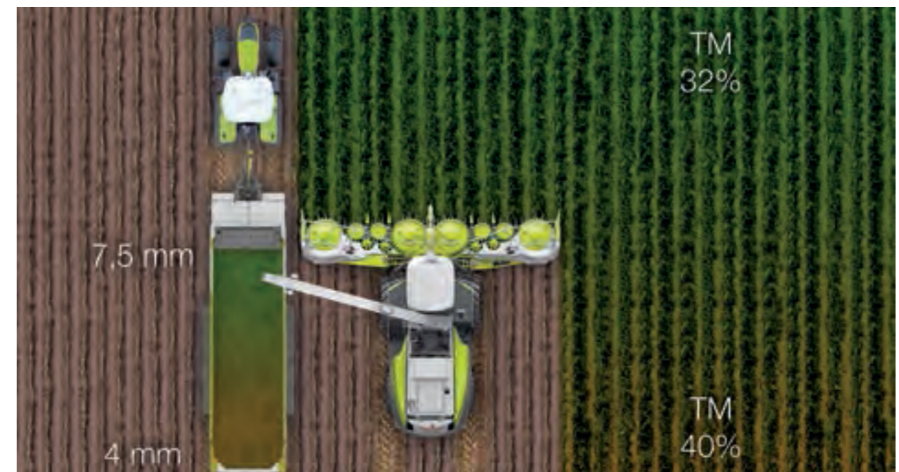
乾燥物含有量に基づく細断長自動調整
