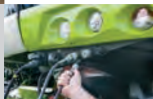
清潔で素早い接続の アタッチメント機能用 油圧カプラ
