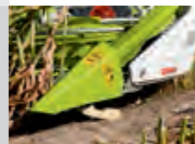
オートコンツァー：サイドレベリング付 接地圧力コントロール (オービス 600/600SD 以上)
