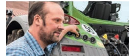
■リアフェンダーにはリンケージと油圧1系統、PTOのON/OFFボタンが付いています。これにより作業機の脱着が容易に行えます。
