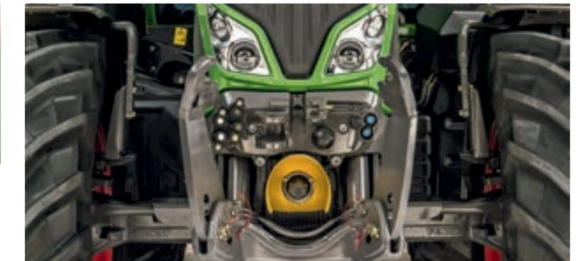
□フロントリンケージはトラクターのフロントハーフフレームと一体構造となっており、非常に安定した頑丈な構造です。リンケージアームは折畳み可能でローダー作業時でも干渉しません。
