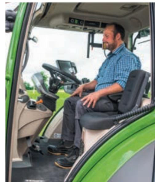
■ステアリングの高さ、角度調節は、ステアリングだけでなく、計器類も同調して動きます。オペレーターの体形に合った調節をする事で作業に適したコックピットの完成です。
