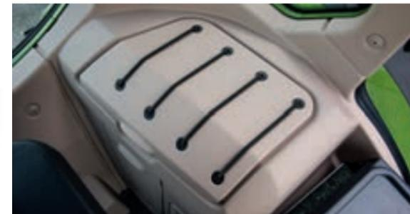
エアコン連動BOXに収納する事でドリンクなどをフレッシュに保つ事ができます。パッセンジャーシートの後ろに配置されたこのBOXは片手で開閉する事ができます。
