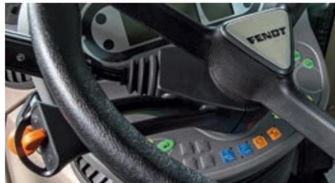
標準装備のクロスゲートレバーが非常に精密なローダー操作を可能にします。オプションの第3、第4バルブは側面の黒いボタンを押しながらレバーを倒すだけで操作できます。
