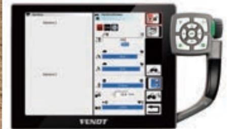
リンケージはバリオターミナルで設定し、専用のコントロールモジュール、マルチファンクションジョイスティック又はリアフェンダー部分のボタンで操作する事ができます。
