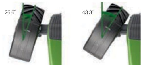
□Profi Plus バージョンに付随するアクティブステアリングによって、ステアリング1回転当たりのフロントタイヤの切れ角を大きくする事ができます。
