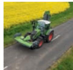
■一体型ショックアブソーバーが道路走行時でも作業機から伝わる衝撃を吸収します。これにより安全で快適な道路走行が可能になります。
