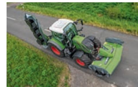
フェント 500 バリオ S4 シリーズは 1,700rpm で 50km/h、1,400rpm で 40km/h と低回転で高速度を実現します。
