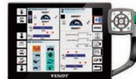
ローダーの機能はバリオターミナルを通して設定する事ができます。例えば、アームに流れる油量なども右側のロータリーダイヤルで容易に、精密に変更する事ができます。
