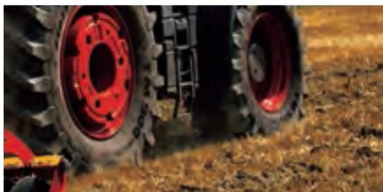
フェントは新機能のバリオグリップをご提案します。この機能は車体と一体化したタイヤ空気圧調整機能です。これによりあらゆる作業下で適切なタイヤ空気圧を選択する事ができます (オプション、専用サイズのタイヤ装着が必要)。
