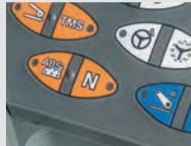
圃場では、この特別なブレーキ性能が圃場表面へのダメージを軽減します。ABS システムはまた、重量のある作業機けん引中の下り傾斜の時などでも安全なブレーキングを保証します。
