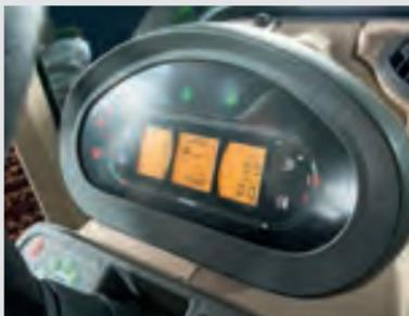
フェント 900 バリオ S4 シリーズのインパネ照明は重要な部分が簡単に視認できるようデザインされています。時刻や周囲の環境に関係なく、重要部分は常に照明によって照らされています。照明の明るさはセンサーによって常にコントロールされています。
