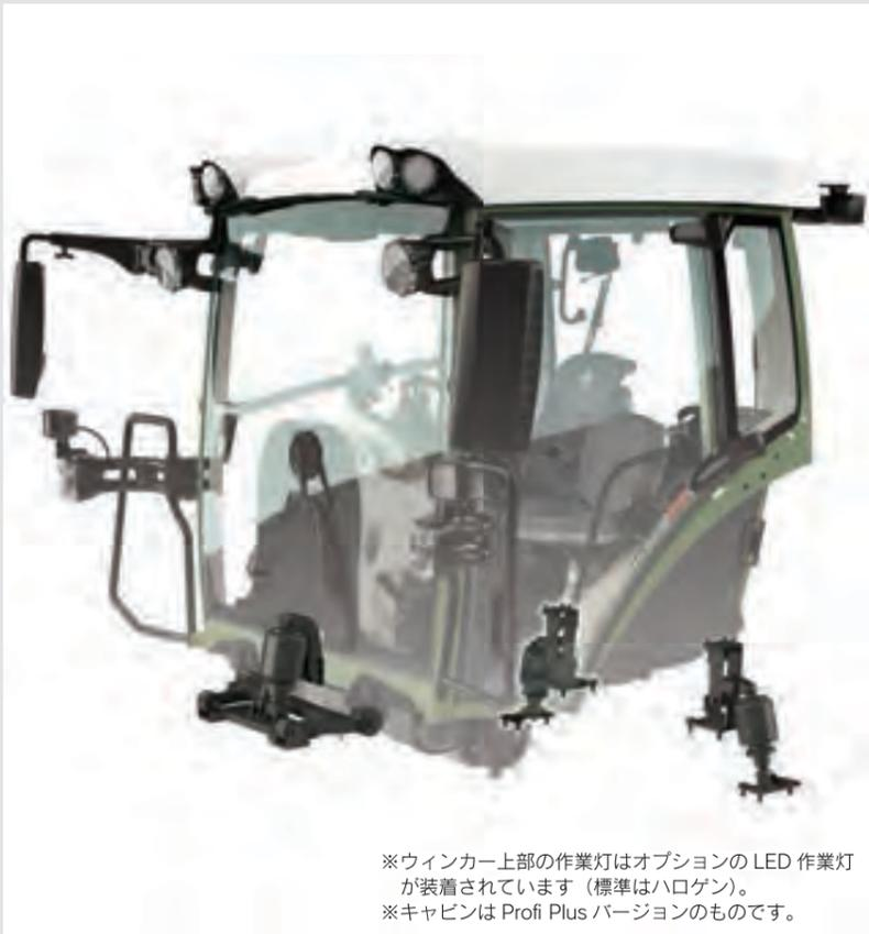
※ウィンカー上部の作業灯はオプションの LED 作業灯が装着されています（標準はハロゲン）。
