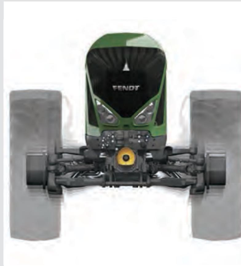
油圧式独立サスペンションはダブルウィッシュボーン方式を採用しており、ステアリング角を大きく取る事ができます。全自動レベルコントロールは左右のサスペンションの高さを確実に同じく保ちます。フロントアクスルは最大 8 トンの荷重まで耐える事ができます。その上、サスペンションの高さは手動で調整する事も可能で、ジョイントとベアリングは、メンテナンスフリーであり、潤滑箇所は 1 つもありません。
