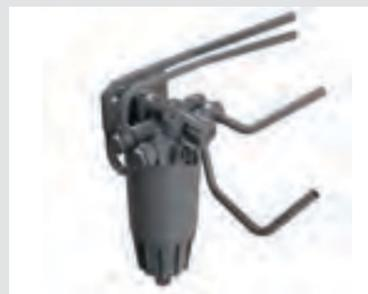
外気温が低い時はヒーター付き燃料プレフィルターが威力を発揮します。この装備は燃料が適温になるまで作動し続けます。これにより燃料噴射システムは更に信頼性の高い物となります。
