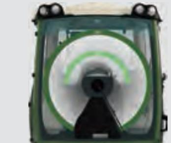
新型ワイパーは 300° の回転角度があり、雨の日でもフロント部分を見通す事ができます。拭取り面積はほぼ倍増し、ボンネットギリギリまで拭取る事ができます。ワイパーの動作間隔を調整する事も可能です。
