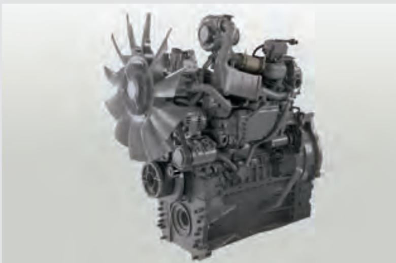
フェント 900 バリオ S4 シリーズは 6 気筒ドイツ製エンジンを搭載しています。力強さと高効率の背景にはツインターボの存在があります。エアは第 1 ターボ、チャージエアインタークーラー、第 2 ターボ、そしてもう 1 つのインタークーラーの順で通過します。これによりエンジンは多くの酸素を受け取る事ができます。そして燃焼効率が最大限に高められます。
