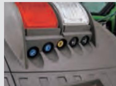
フェント 900 バリオ S4 シリーズはリンケージ、外部油圧、リア PTO 及び外部油圧 1 系統の外部コントロールが装備されています。作業機の取付けが簡単になります。このボタンでリア PTO をオンにした場合にあらかじめ設定したエンジン回転数に自動的に回転が上がるので希望の PTO 回転数を得る事ができます。バキュームタンクなどを装備している時に、回転を上げるためにキャビンを乗降りする必要がありません。
