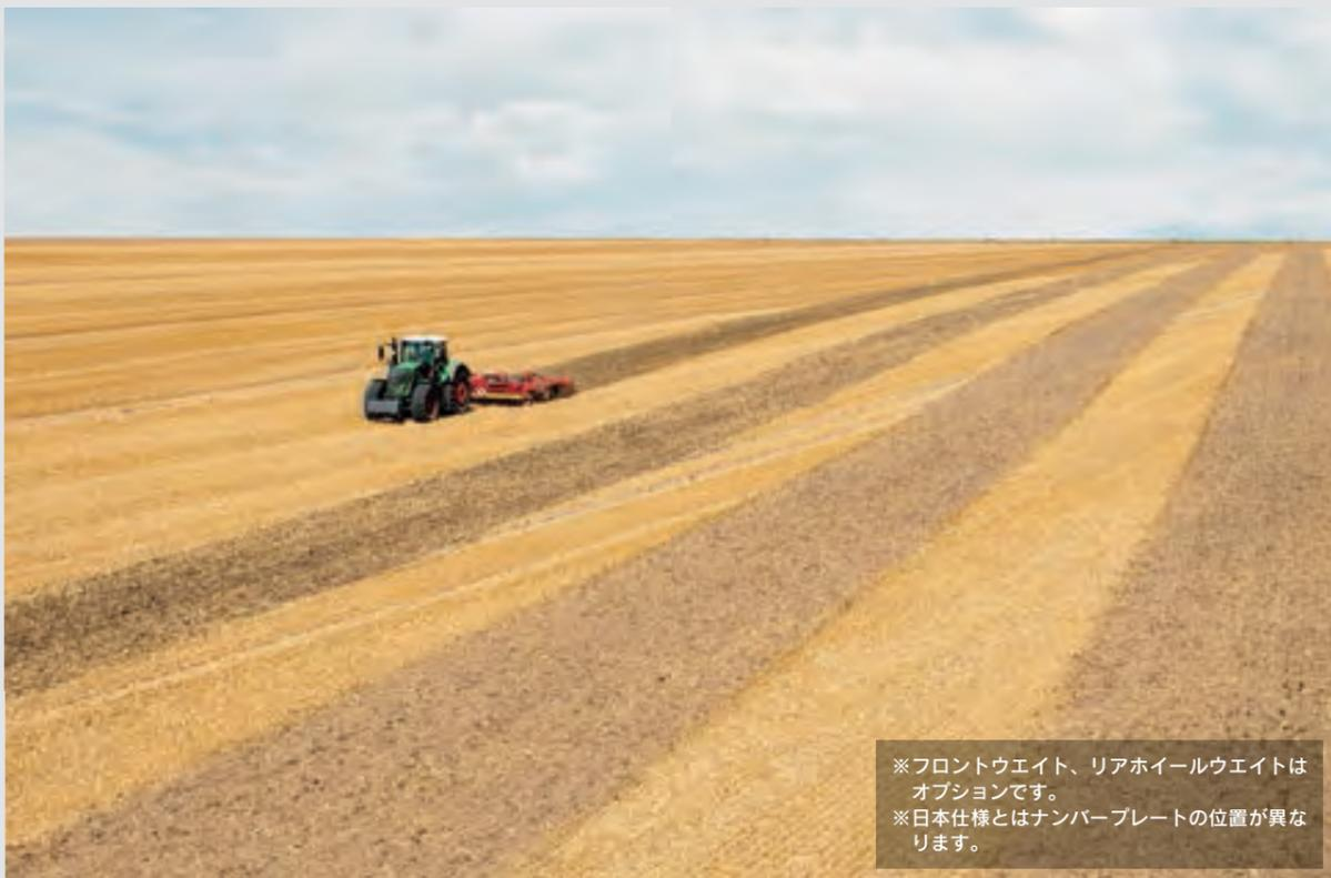
バリオガイドがあれば、オペレーターは作業機操作だけに集中する事ができます。これにより視界が悪い日の作業でも作業の精度を落とす事なく仕事を終える事ができます。このシステムはアメリカのGPS信号だけではなく、ロシアのGLONASSからの信号も捕捉して自動操舵に使用する事ができます。どちらの衛星信号も捕捉できるという事はオートステアリングを安定的に使用する事ができるという事です。上記2つの衛星信号の補正方法はユーザーのニーズに応じて選択する事ができます。自ら基準局を設置するRTKシステム、MSASやOmniSTARの様に衛星からの補正情報を使用するシステム、インターネット回線を使用したNトリップなどが使用可能です。バリオガイドはRTCM3.1の様なオープンフォーマットにも対応しています。即ちオペレーターは±20cmから±2cmまで3つの精度から希望する補正方式を選択する事ができるという事です。
