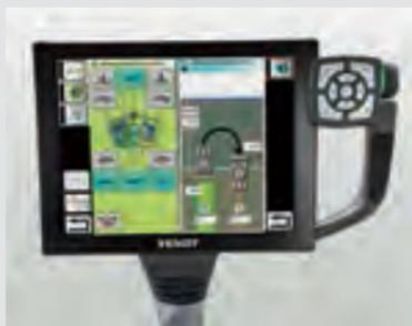
要求に応じて作業機コントロールとティーチンをそれぞれのボタンに振分ける事ができます。オペレーターは好みに応じた完璧なボタン設定を得る事ができます。オプションのティーチンオートマッチクを使用する事によりトラクターが圃場の終端に来た時に自動的にティーチンを作動させる事ができます。
