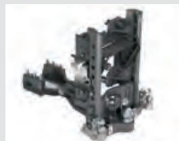
近年の多様なステアリング機能付きヒッチに対応するためにフェントは ISO/DIN26402 に適合したステアリングヒッチ対応カップリングを用意しています。標準的なボールヒッチに対応した形状になっています。
