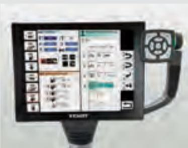
ティーチンの一連の動きを記憶させるのは、停止状態で焦らずゆっくりと希望の動きを入力する事をお勧めします。後から必要に応じて、作業中に微調整を行う事ができます。
