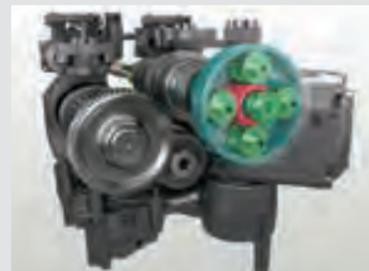
トランスミッションは 330 馬力以上を出力するトップモデル向けにデザインされています。ミッション内部には動力伝達と耐久性を高めるための 4 つの遊星ギヤが装着されています。
