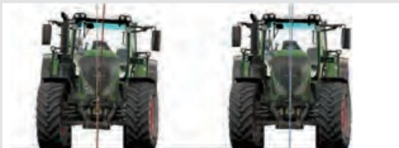
20km/h より高い速度で、フェントスタビリティコントロール (FSC) は、左右の傾きを補正して、正確なハンドル操作、走行安全性、安全な制御を全く新しい次元で行います。走行速度が 15km/h 未満の時にも左右の傾きの補正が働き、最も良い接地状態を保証します。
