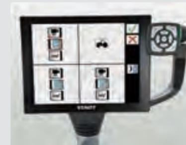
➡ ターミナル上には最大4つまでの情報を同時に表示する事ができます。どこの部分に何を表示させるかも選択可能です。また、最後の作業時のセッティングもエンジン始動時に呼び戻す事ができます。
