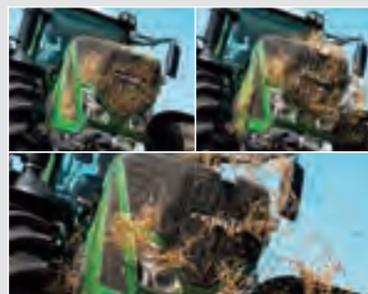
フェント 900 バリオ S4 シリーズのリバースファン（オプション）は必要とされる自浄動作を効率的に行います。ファンが自動で逆転する事によりグリルに付着したチリや埃を吹き飛ばし、クリーンな状態を保ちます。特長：冷却部分からの要求に応じてファンの羽根の角度を変えるため、無駄な燃料を消費しません。
