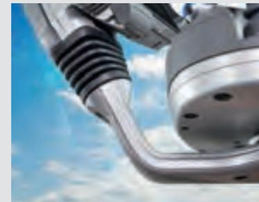
➡ バリオターミナルの位置と角度は希望の位置に調節可能です。ブラケット内のボール型ジョイントがあらゆる角度への調整を可能にしています。オペレーターはターミナルを常に見やすい状態で使用する事ができます。
