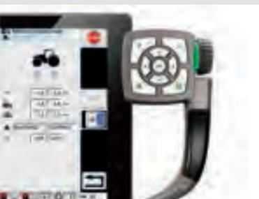
バリオグリップの操作はバリオドック上で簡単に行う事ができます。過高圧、過低圧時にはアシストシステムがオペレーターに警告する機能も装備しています。
