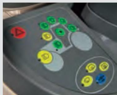
**作業灯は操作しやすく、わかりやすいコンソールによって制御されます。**
