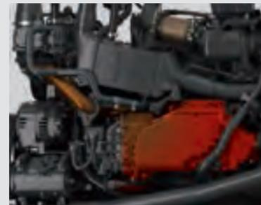
EGR システムは排気ラインに入る前の窒素酸化物 (NOx) を大幅に減少させます。これにより AdBlue の消費量が大幅に減少します。
