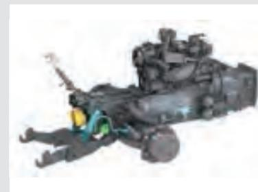
フロントリンケージにはロードリリーフコントロール機能が装着されています。この機能は設定した圧以上の力がフロントリンケージにかかった場合その力をトラクター本体に逃がす役割を担っています。設定圧は作業中でも変更が可能です。これにより雪道での作業やマルチチャー作業時のステアリングの安定性が増すという利点を提供します。
