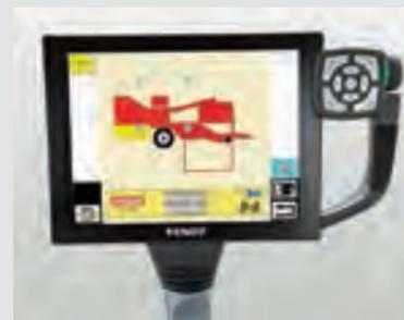
ISOBUS 作業機コントロールの制御はバリオターミナルで行います。作業機の状態はターミナルで、操作はジョイスティックで行うので追加のターミナルは不要です。フルスクリーン表示の時、バリオターミナルは完全に ISOBUS ターミナルそのものとして使用する事ができます。
