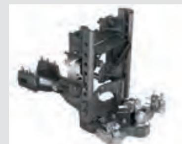
ボールヒッチは後ろに 165mm 長いタイプを選択できます。これは垂直荷重で 3.3 トンまで耐える事ができます。左右だけでなく上下の動きにも対応できるため、安全性が向上する事とぎついカーブでも素早く対応する事が可能です。
