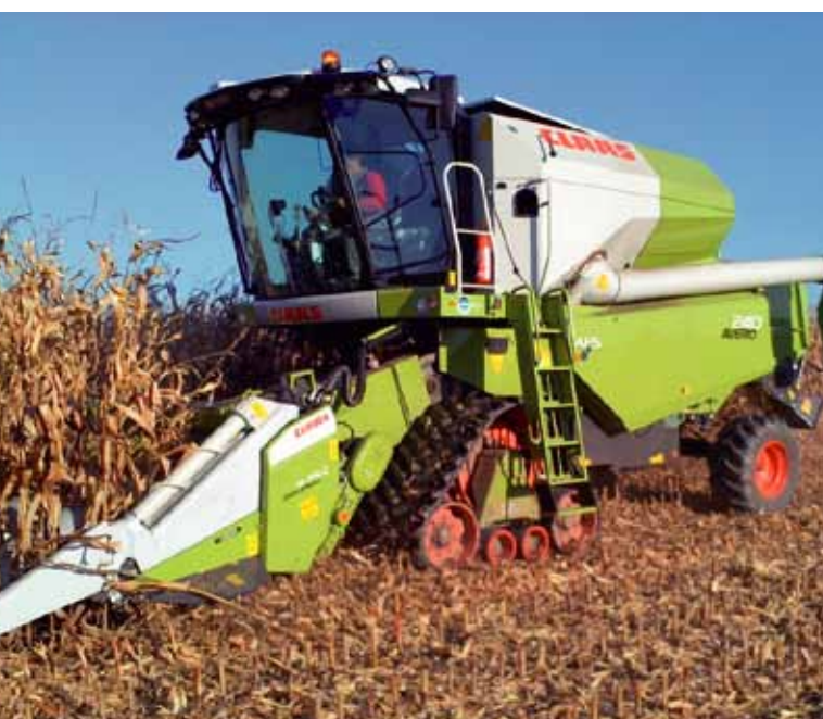
▲コンスピードとハーフクローラーを装着したクラスアベロ240コンバイン。
