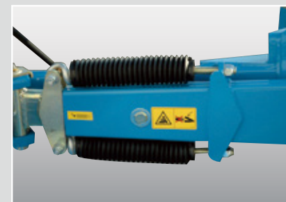
安全システムを備えた伸縮式アームが作業走行中の衝撃を吸収
