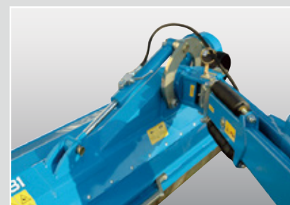
長さ 1500mm のアームは根元に向かって太くなる構造で、衝撃を分散させる設計
