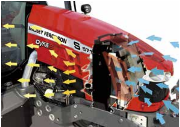
▲ 広いグリルとコンポーネント間にある隙間によってすべてのラジエーターが外気に触れることができ、最大の冷却能力を実現します。
