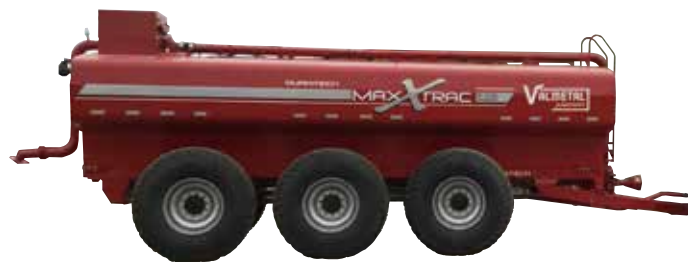
ステンレス・スチールタンク (オプション) (型式: MX-STAIN-○) さらなるタンクの耐久性をお求めの場合、ステンレススチールタンクを選択可能で長寿命に貢献します。
