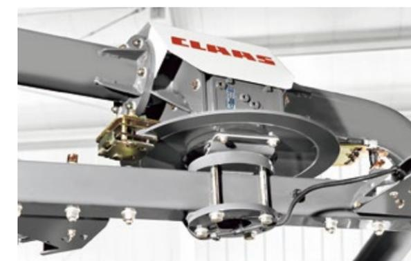
外側に取り付けられたプレートが傾斜した地形でも正確にベールを中心に寄せます。トランスファープラットフォームがその後、ベールを載せやすくするためにベールチャンバーに向かって傾いているラッピング台まで安全にベールを持ち上げます。
