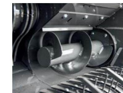
ピックアップとチャンバーの間に2つのフィードオーガーが装備されています。シャフト径が大きいため、作物を押しつぶすことなくローターへ供給します。
