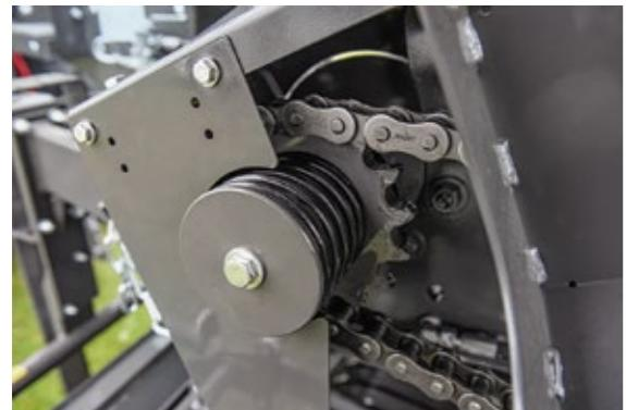
フリーホイールスプロケットは、ローターに作物が詰まつたとき、ドライブトレインを損傷から保護します。
