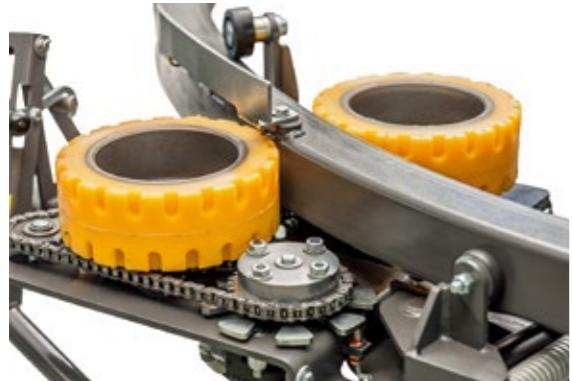
油圧駆動のラバーローラーがラッピングリングを制御し、安定したラッピングを可能にする適切な速度まで短時間で到達します。
