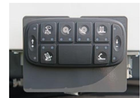
手動操作用のリヤコントロールパネルでもベーリングとラッピング作業を簡単に操作できます。
