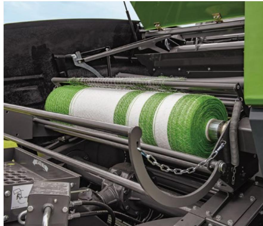
イージーロードシステムによって、ロールネットの交換を最短時間で行えます。
