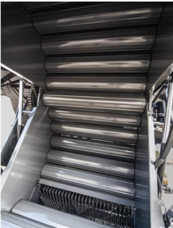
パワーグリップローラーは常に3本のリブでベールに接触し、ベールを回転させます。
