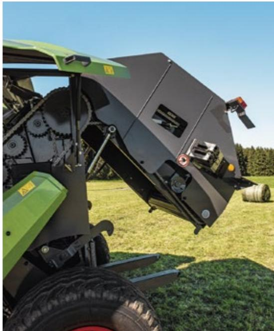
機械式テールゲートロックにより、斜面で使用する場合でも確実にテールゲートを閉じる事ができます。
