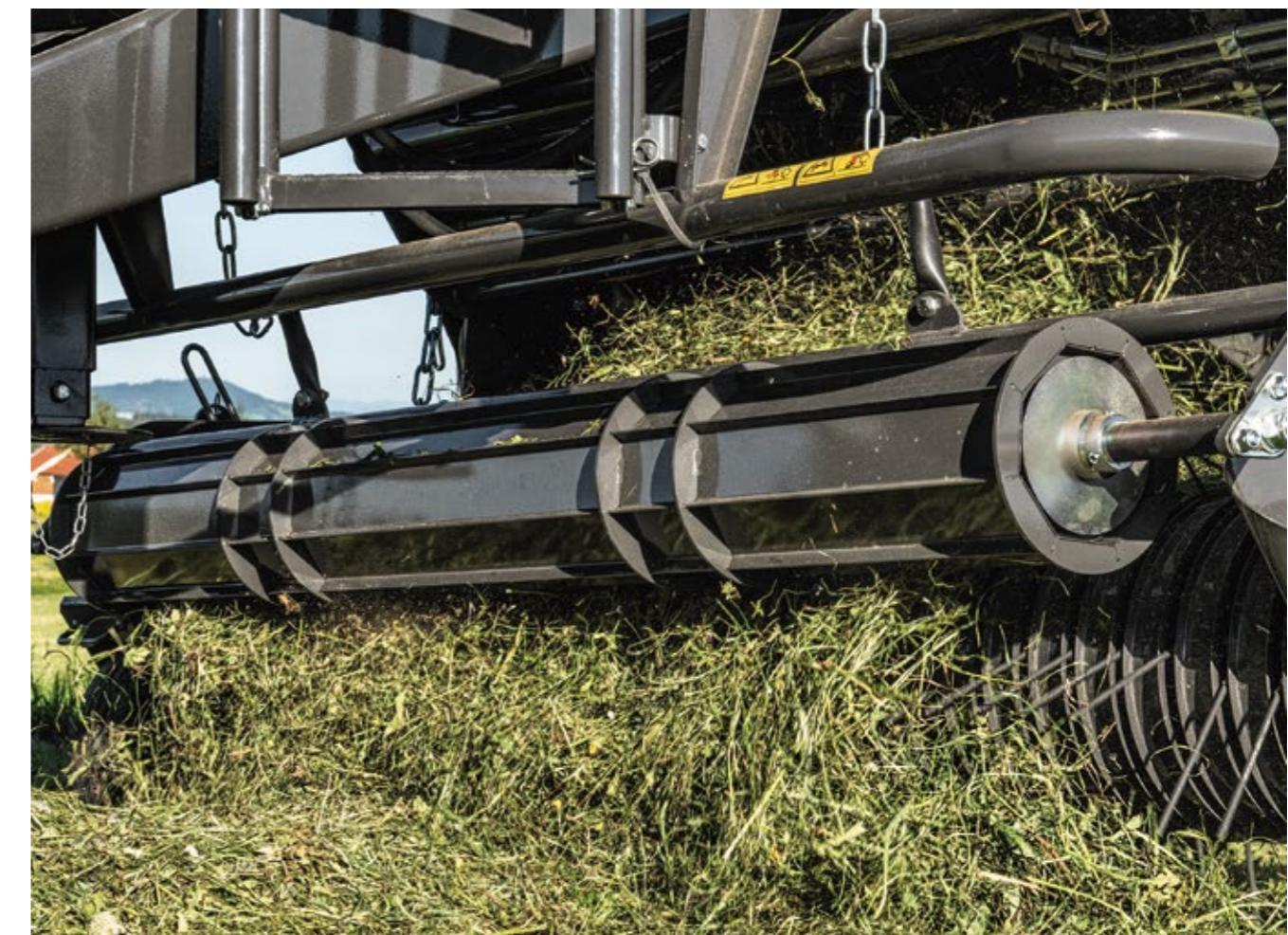
シンプルな構造のピックアップは、メンテナンスが容易でスムースに動作します。
