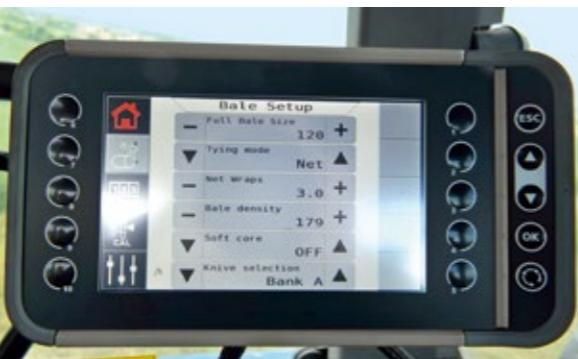
E-LinkProはISOBUSの操作ターミナルで、ベーラーの機能をタッチパネルで制御します。
