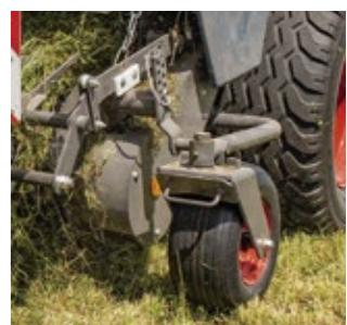
ピボット式のピックアップホイールは10段階の高さで調整可能です。
