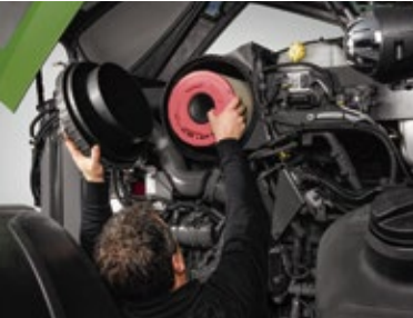
エアフィルタの汚れはバリオターミナルに表示されます。エンジン部分は作業がしやすく、サイドパネルは素早く外す事が可能です。
