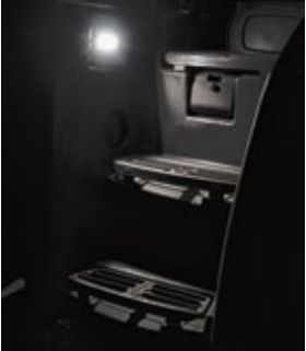
タンクの横に組み込まれたステップ用照明により、安全にキャビンに乗り降り可能です。
