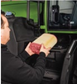
フィルターは外しやすく、必要な時に簡単に清掃可能です。
