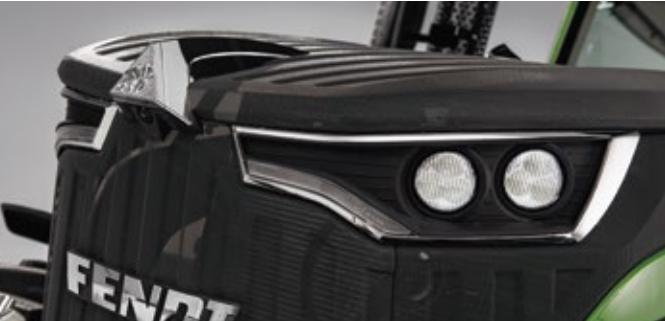
前面の作業エリアを4つの強力なLEDヘッドライトで照らします。LED前照灯で路上が見えやすくなります。
