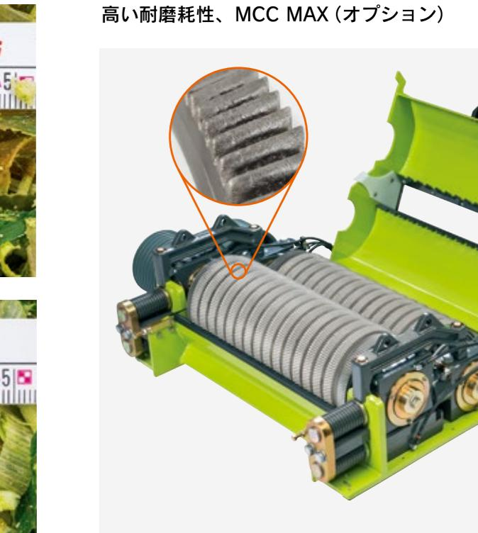
MCC MAXローラーコーンクラッカー（オプション）はメイズ、WCS、コブサイレージ等あらゆる飼料に適しています。新型JAGUARのローラーはBusaDUR®高耐磨耗性コーティング処理が施されているため、耐用年数が向上しています。
