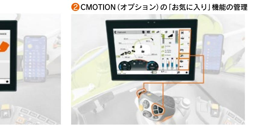
「お気に入り」として7つの項目を画面上に常駐可能で、CMOTIONレバーのスイッチを使ってそれらのプログラムに素早くアクセスできます。これにより片手は制御レバーに乗せたまま、フロントアタッチメントとクロップフローに集中することができます。
