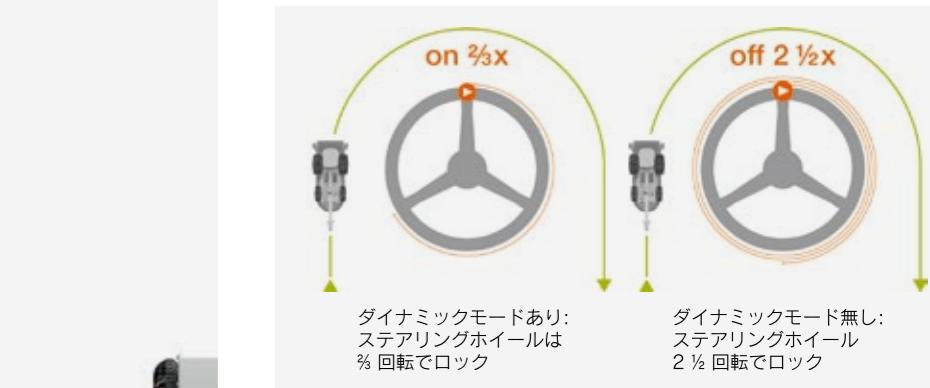
JAGUARは旋回する際にステアリングホイールをロックtoロックで5回転要します。枕地旋回する際ステアリングの回転を少なくした方が、オペレーターにとって快適です。ダイナミックステアリング装置はこれを可能にします。
