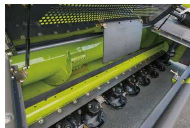
マックスカットモアバーで細断された作物は、高さ調節可能なパドルローラーによってインテークオーガーに供給されます。これにより、短い作物でも極めて一貫したクロップフローを実現します
