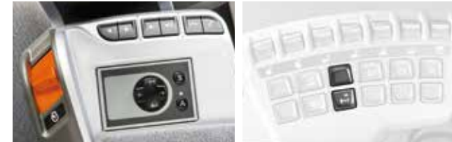
傾斜補正の操作系統はすべてアームレストにまとめられています。
