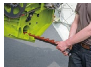
カッターバー下の交換用ナイフ保管スペース
