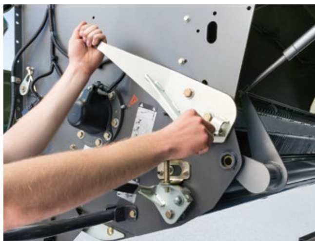
固定ナイフ配列とフリクションコンケーブプレートの機械式調整
