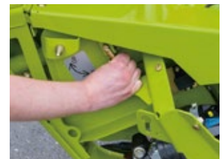
デバイダーと菜種ナイフはクイックリリースシステムによって工具を使わず安全に脱着することが可能
