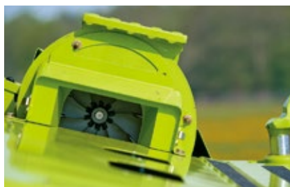
よりクリアな視界: フィーダーハウジングのダスト除去 (オプション、HPフィーダーハウジングに標準)
