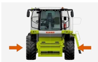
大きい接地面積と全幅の狭い移動幅
