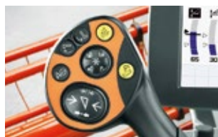
オートマチックカッターバーコントロールは多機能レバー上での高さ調整のためのボタンを押すだけで簡単に作動します。
