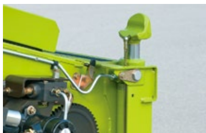
AUTO CONTOUR (オートコンツアー) シリンダーは確実なクリーンカットを行います。
