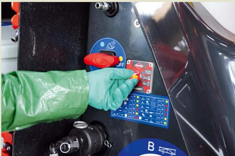
オプションのDILUSET(ダイリュセット)とe-セットバルブ設定・切替システムはスプレーヤーのタンクに対して事前に設定した容量に基づき自動的な吸水を行います。e-セットだけのプラスワンの特長：トラクターキャビンに乗込む事なく、外側に設置されたメーターにより確認できます。
