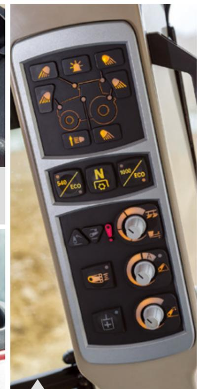
ピラー部分に配置されたPTO回転数ボタンとリンケージコントロールスイッチ
