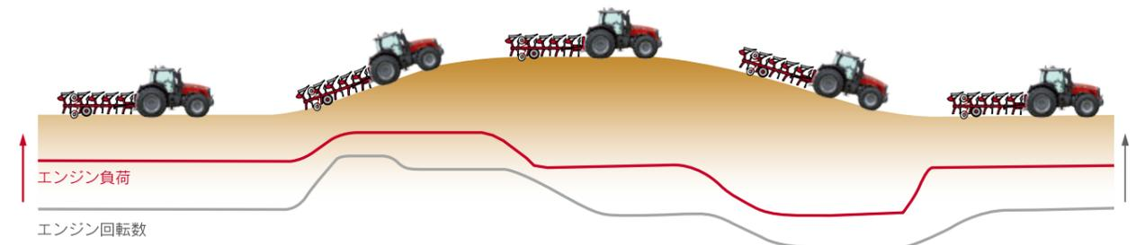
▲ DTM ダイナミックトラクターマネジメント：負荷（赤い線）が作業状況によって変化すると、Dyna-VT はエンジン回転数（灰色の線）を調節して、前進速度を維持します。
