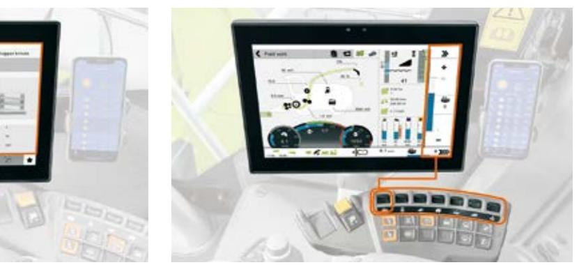
7つの基本的な機能を割り当てられたスイッチを使用して走行中でも直接操作できます。例：セクションスイッチを介して作業幅の調整。
