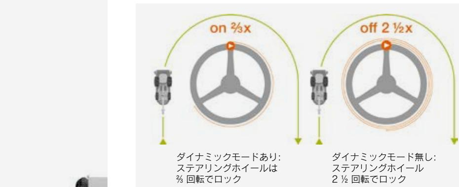
JAGUARは旋回する際にステアリングホイールをロックtoロックで5回転要します。枕地旋回する際ステアリングの回転を少なくした方が、オペレーターにとって快適です。ダイナミックステアリング装置はこれを可能にします。
