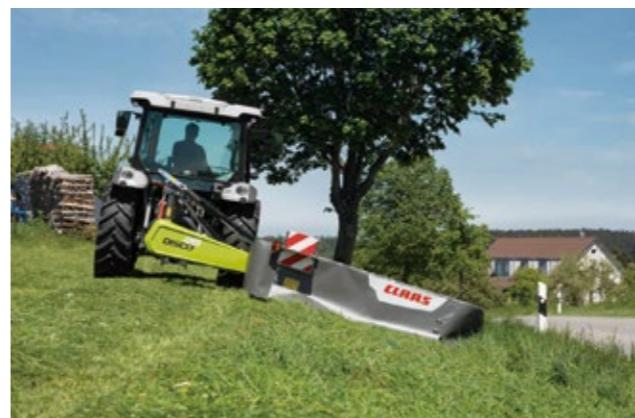
ディスコ2桁シリーズは、特別に強化されたコンポーネントと重量を意識した設計により、傾斜地での作業に適しています。このシリーズは、勾配が45°程度であれば、道路の側溝や堤防の草刈りにも最適です。(長時間傾けたままの作業はお控えください。)
