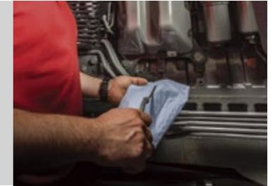
エンジンエアフィルターも手が届きやすく、清掃が容易に行えます。マフラーで発生する負圧を利用して、最大90%の塵や埃を取り除くプレクリーナーを装備しています。
