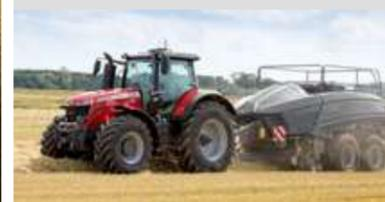
ウエイトとタイヤの空気圧を正しく設定する事で、けん引力を向上し、土壌への踏圧を低減できます。ウエイトバランスを正しく選択すると、次の事が可能になります。
