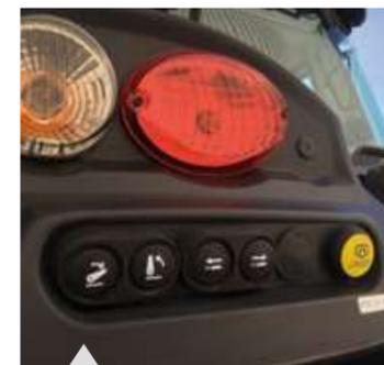
フェンダーに取り付けられたPTO、油圧スプールバルブおよびリンケージコントロールスイッチ
