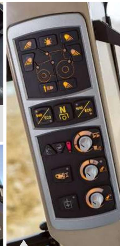
ピラー部分に配置されたPTO回転数ボタンとリンケージコントロールスイッチ
