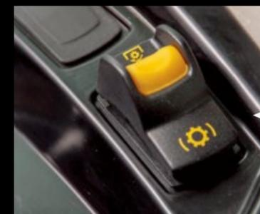
PTOのスイッチは3段階の安全設計で電子式スイッチにより駆動します (ON/OFF/ロック)。
