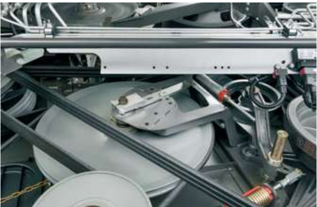
タインがストローに入り込む深さは調整が可能
