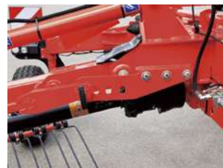
GA7501PLUS：機械式集草幅調整
