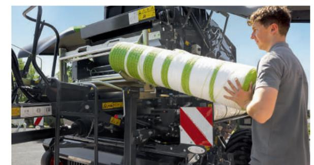
VARIANT500シリーズでは、新しいネットラッピングシステムが25cm低い位置に設置されており、ネットブレーキ下のネットロールを簡単にクリーニングできるようになっています。
