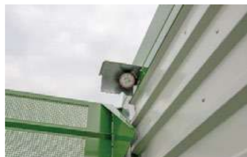
荷台内部 LED 作業灯
