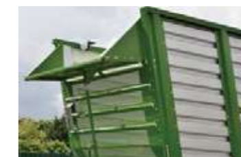
フロントウォール 前壁 (600 mm) の上部セクションは、干渉のない充填のために折り畳むことができます。
