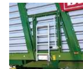
アクセスポア (左) 折り畳み可能なはしごを利用し荷台へ容易にアクセスできます。
