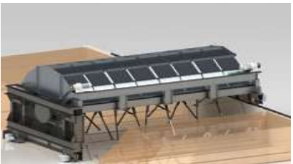
オープンロータリー攪拌装置
