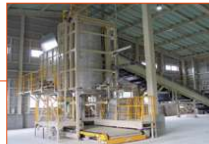
縦型圧縮梱包機 コンベアで運ばれたTMRを圧縮。その後袋詰め。
