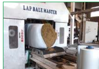
TMR 六面包装圧縮梱包機 投入されたTMRを圧縮しストレッチフィルムにて六面包装する。
