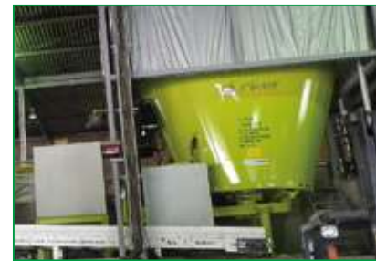
定置式ミキサー 投入された飼料を混ぜ合わせる機械。オーガータイプは縦型、横型がある。
