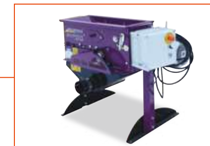
穀物粉砕機 乾燥飼料米穀物を粉碎脱穀する機械。家畜にとってより適した飼料を作る。
