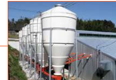
飼料タンク・チューブコンベア 配合飼料を保管供給する機器。
