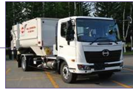
自走式ミキサー 国産のトラックに KUHN のミキサーを搭載した自走式ミキサー。
