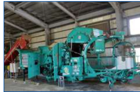
コンビラックマシーン ロール形成からラッピングまでを自動で行う。新鮮な状態で即ラッピングできる。
