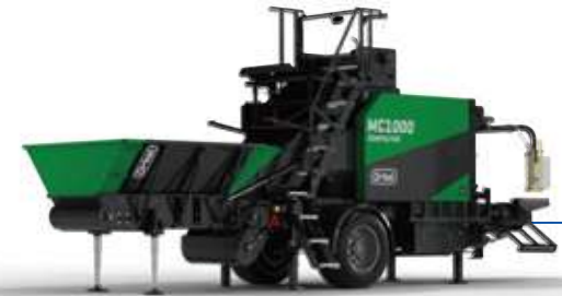
マルチコンパクター ロール形成・ネット巻き・ラッピング・ロール排出を自動で行う。幅広い形状の飼料を巻くことが可能。
