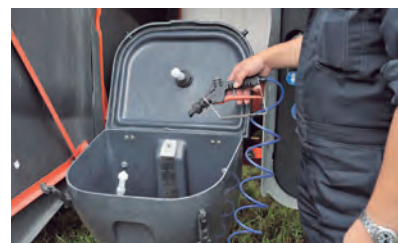
スプレーヤー側面に備わる薬剤ミキシングタンク
