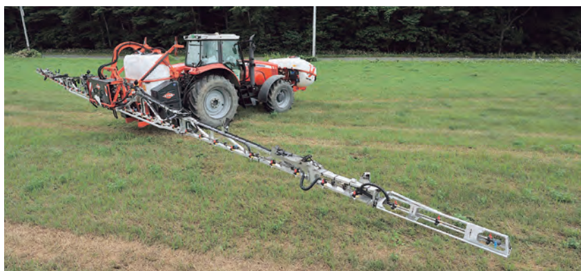
軽量のアルミニウムのブームは3Dサスペンションによりしなやかな動きで先端のセクションは外部からの衝撃に対し、ブレイクバックする構造
