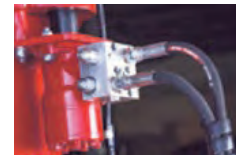
シュート旋回のための油圧システムを搭載
