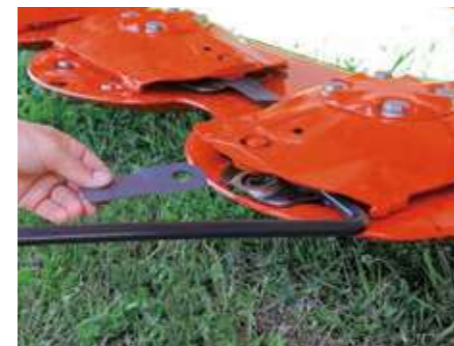
FF:ファストフィット装備 ナイフを簡単に交換することができます。
