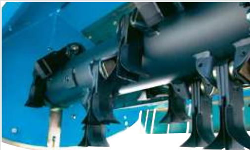
620mmの大径ローターが多量のシュレディングを可能に
