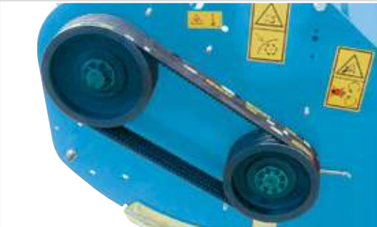
高強度のベルトと大径プーリーによる効率的な動力伝達
