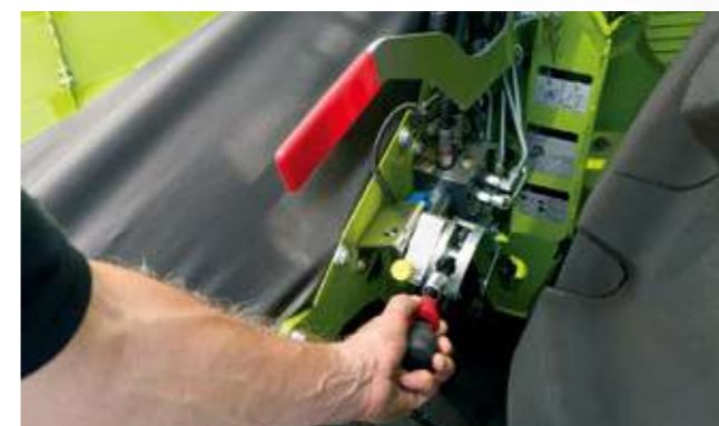
作物の流れを最適にするためのインテークドラムの3段階の速度調整
