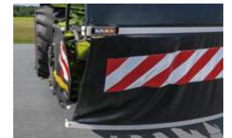
側面と前面の保護は、警告ステッカーではっきりとわかります。LED照明は完全に統合されています。
