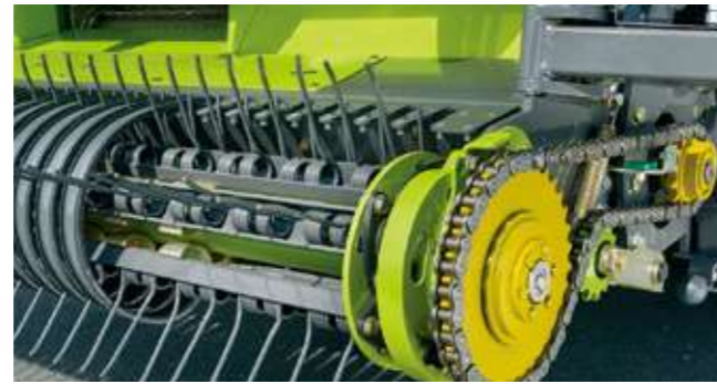
作物を効率的に取り込むための堅牢なPICK UPリール
