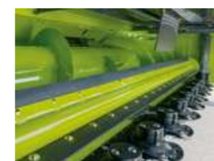
DIRECT DISC 500 P 油圧で高さ調節可能なパドルローラー
