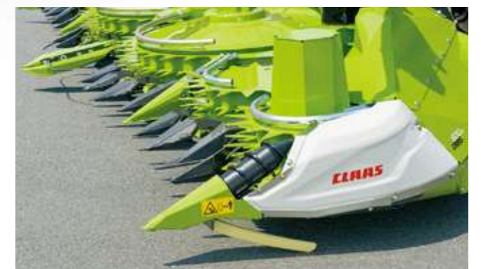
必要に応じて、倒伏メイズオーガーを油圧駆動
