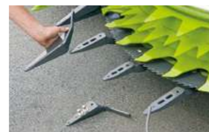
取り外し可能なガイドフィンガーにより、倒伏トウモロコシ刈り取りを向上。
