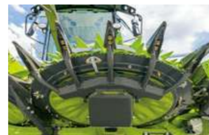
切断ディスク下の堅牢なガイドフィンガーとディスクチャージャーで確実な作業実現
