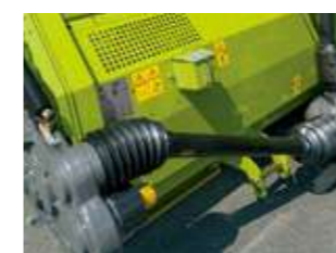
3速ギアボックスを備えたパワフル なドライブシャフト
