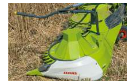
大きなサイドコーンは作物の流れを最適化し、作物が搬送ディスク上に残るのを抑制
