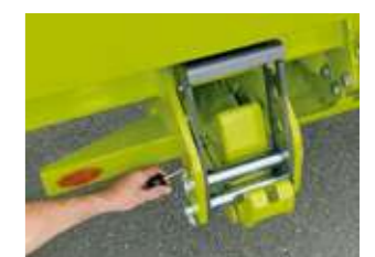
フロントアタッチメントを固定すれ ば、最高時速でも安全に道路走行可能
