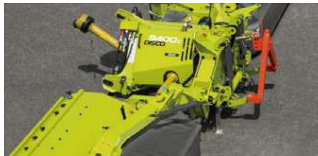
油圧式ノンストップ衝突保護により衝突時にモアユニットが上に持ち上がり、その後自動的に元の位置に戻ります
