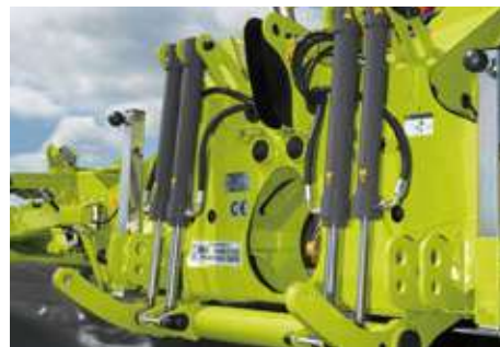
モアユニットのリフト用とACTIVE FLOAT接地圧調整用の油圧ピストンが草地へのダメージを抑えます
