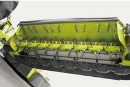
オプション クロップスプレッダー(DIS-WS-A / DIS-WS-B) 刈り取った作物を広範囲に広げます。
