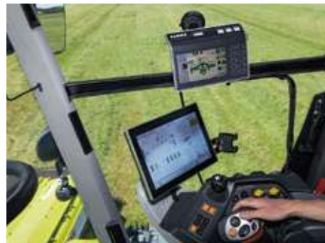
ISOBUS対応端末やコントロールレバーのファンクションキーなどによる快適な操作
