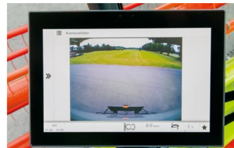
CEBISモニターにはリアカメラからの映像を表示できます。
