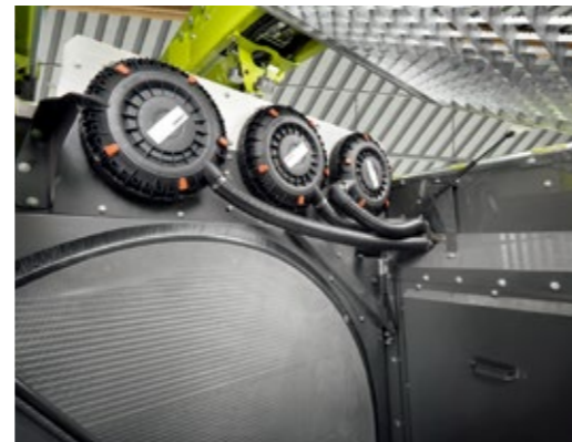
▲ 確実にエンジンに空気を送り込むため三つのエアフィルターはメンテナンスのしやすい構造になっています。
