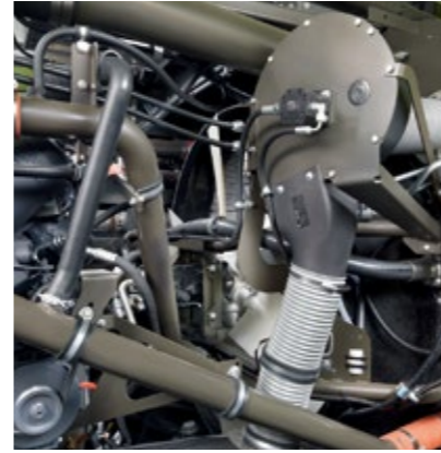
▼ 吸気ファンは圃場での作業中も道路走行中も常に動作します。
