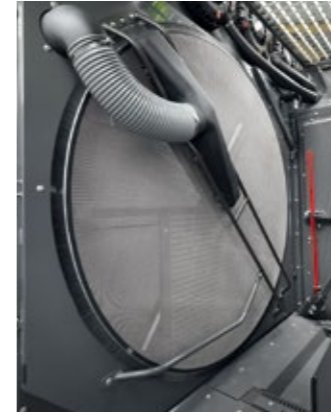
◀ 大型の回転式ラジエータースクリーンは常に吸気ファンによってクリーニングされ、内側のブラシは必要に応じて作動します。
