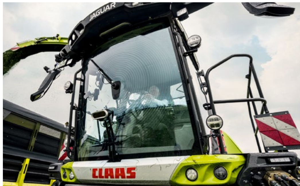
▲ ウィンドスクリーンワイパーには一体型のウォッシャー液噴射装置が組み込まれており、厳しいコンディションでも視界を確保します。
