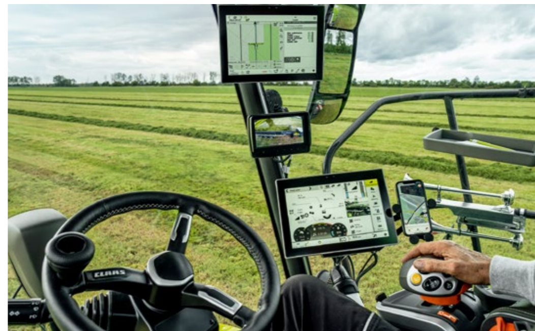
▲ 使いやすいタッチスクリーン付きのCEBISモニターとオプションのCEMISモニター
