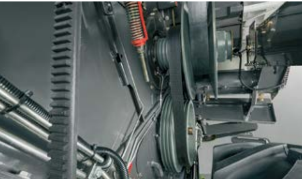
簡単に設定できる2つの速度範囲の脱穀ドラムドライブ。
