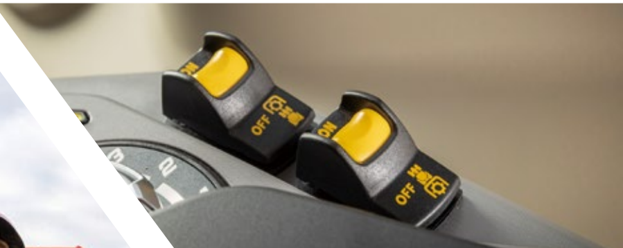
電気油圧式PTO速度選択ボタン
