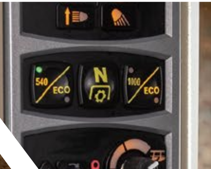
電気油圧式PTO速度選択ボタン
